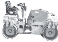
Tandem-Rüttelwalze 2,7 To, 1200 mm, 40 kN
